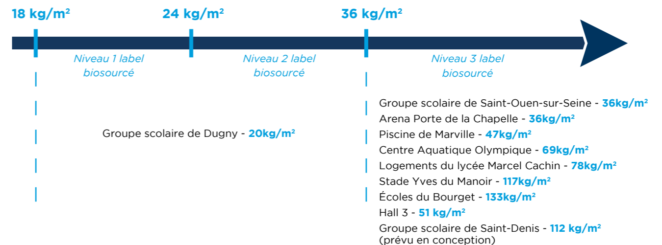
Taux d'incorporation de biosourcés des principaux équipements publics et sportifs et des piscines
